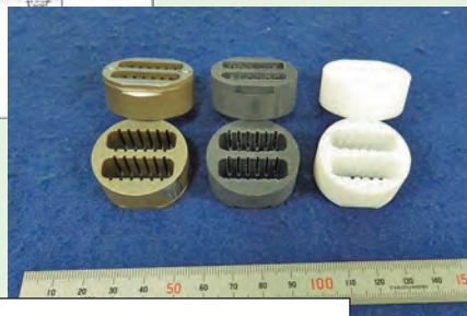
「ウエハー固定具」 材質：ステンレス、テフロン（黒・白）
